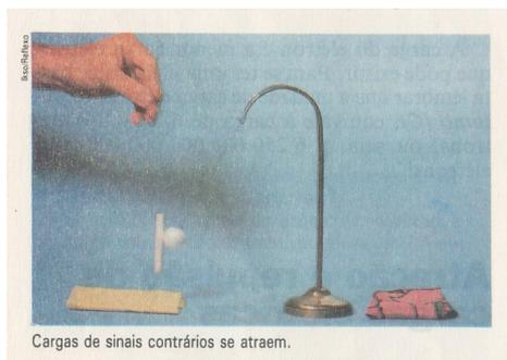
O ELETROSCÓPIO SERVE PARA DETECTAR A PRESENÇA DE ELETRICIDADE ESTÁTICA NOS CORPOS.
